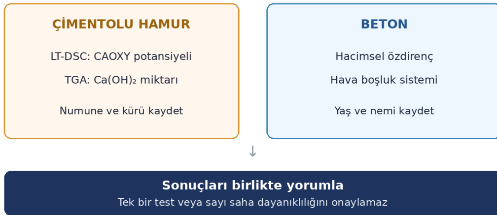
Şekil 9. CAOXY direncinin değerlendirilmesine yönelik test yöntemi seçim karar ağacı [16]
