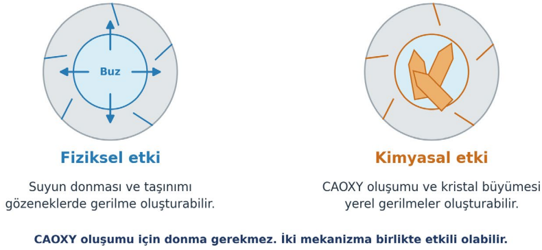
Şekil 5. Donma-çözülme ve CAOXY kaynaklı hasarın şematik karşılaştırması [1,14–16]
