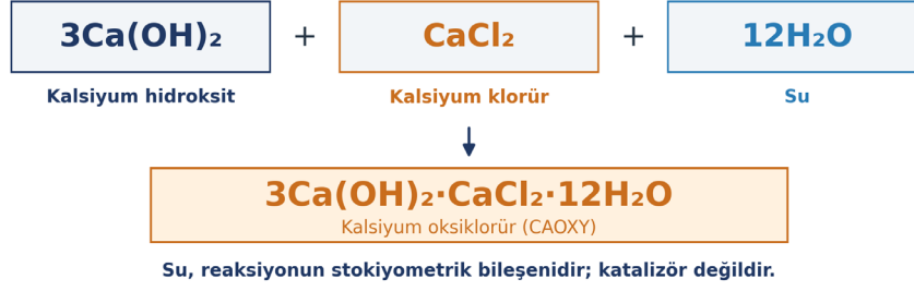
Şekil 3. CAOXY oluşumunun stokiyometrik gösterimi ([1,9,16] temelinde hazırlanmıştır)
