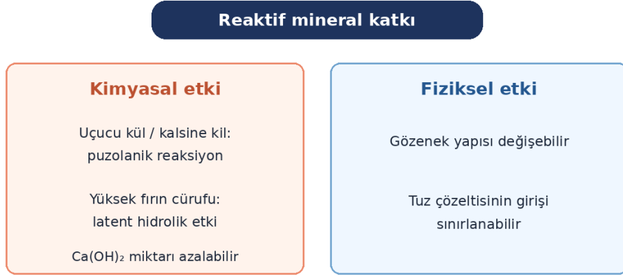
Şekil 10. Mineral katkı kullanımının çift etkili koruma mekanizması [16,18]
