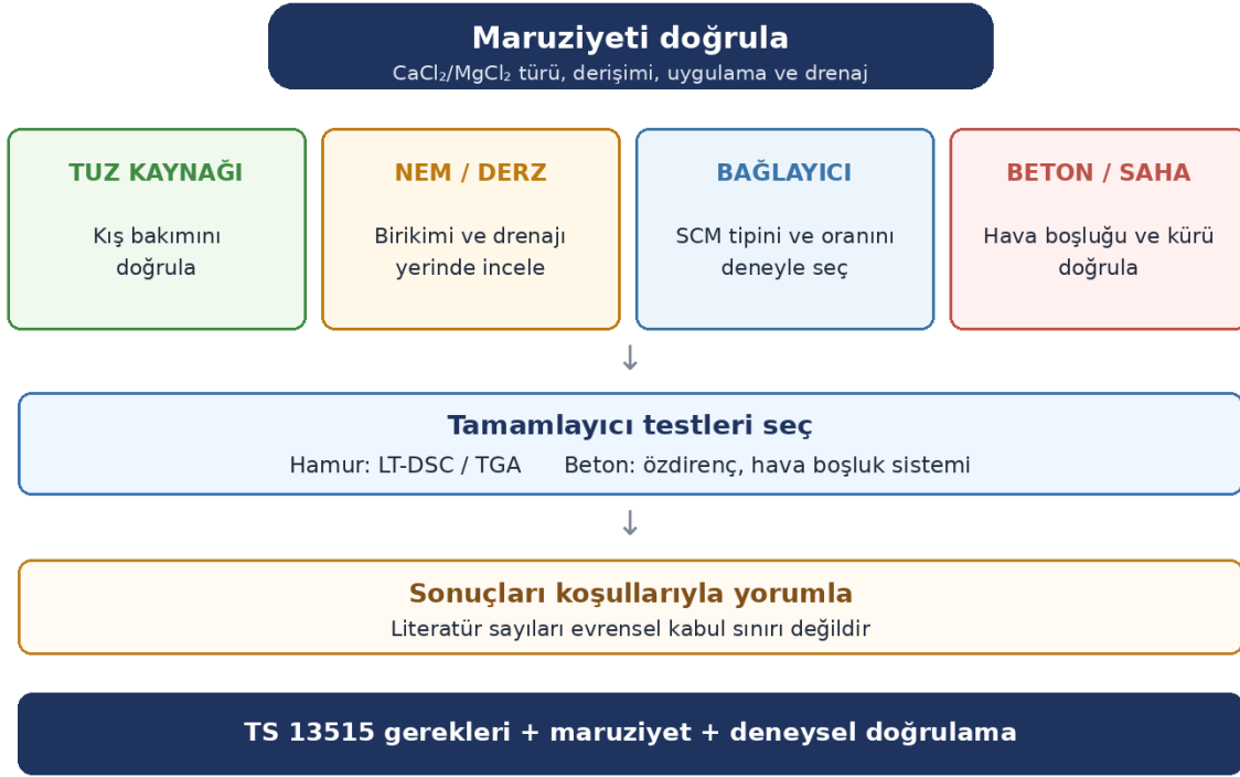
Şekil 12. CAOXY riskine göre karışım tasarımı [16,18,19]
