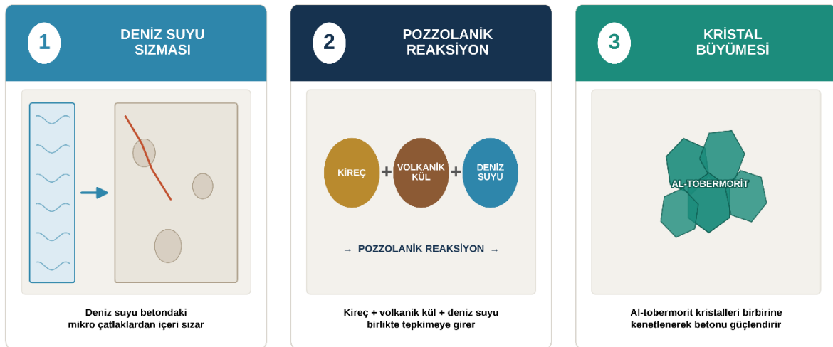
Şekil 3. Deniz suyunun Roma liman betonu içine sızarak Al-tobermorit kristal büyümesini tetiklediği pozolanik reaksiyon şeması [5, 6]
