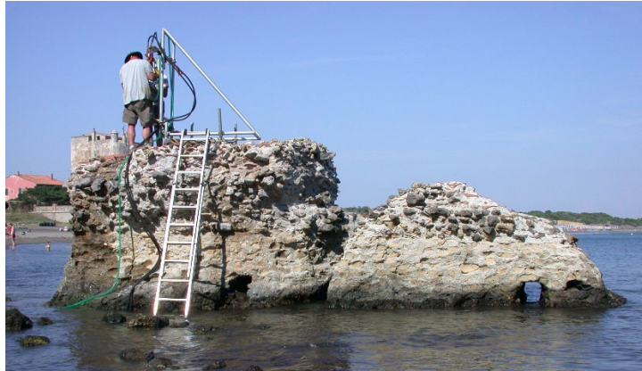
Şekil 2. Toskana'da, 2000 yılı aşkın bir süre önce inşa edilen Portus Cosanus'daki deniz yapısında sondaj çalışması
