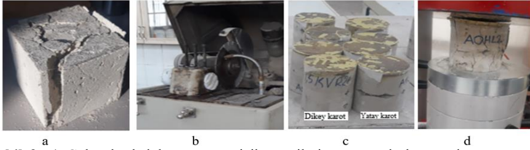
Şekil 3. a) Geleneksel döküm yöntemi ile üretilmiş numunede basınç dayanımı testi sonrası oluşan hasar, b) Karotların kesilerek düzeltilmesi, c) Karotların kükürt ile başlıklanması, d) Karotlara basınç dayanım testi uygulanması.
