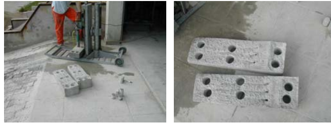
Şekil 10. L-kutusu numunelerinden karot çıkartılması
