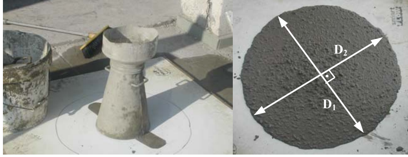
Şekil 2. Yayılma deneyinde kullanılan huni ve 50 cm'lik çap işaretli tabla, nihai yayılma çapı
