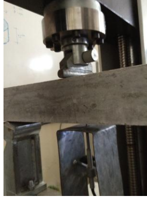
Şekil 2. Tek noktalı eğilme deneyi
