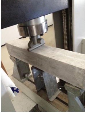
Şekil 2. Tek noktalı eğilme deneyi
